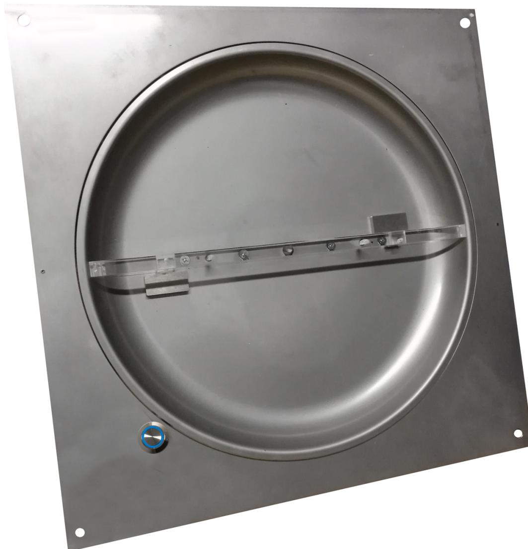
Piatto girevole robotizzato in acciaio inox che, mediante pressione di un pulsante compie una rotazione di 180°, permettendo lo scambio di denaro e biglietti tra interno ed esterno. Il sistema di blocco meccanico, impedisce la rotazione manuale del piatto, garantendo un elevato grado di sicurezza. È dotato inoltre di un'ottima isolamento termica per bloccare l'entrata di aria fredda dall'esterno all'interno.
